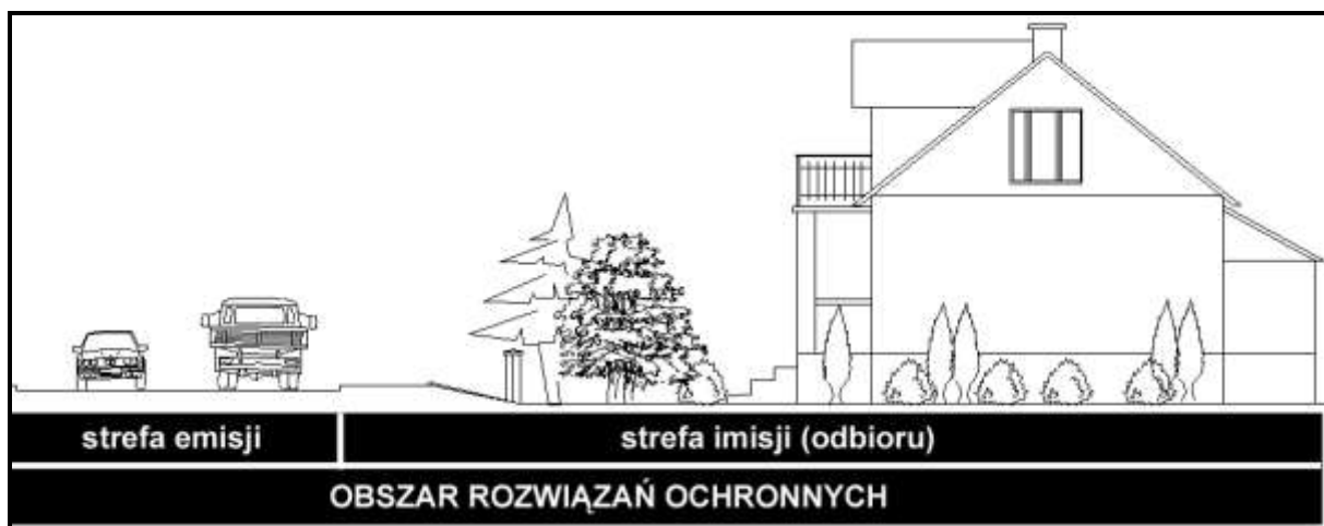
Rys.10. Strefy emisji i imisji hałasu oraz obszar rozwiązań ochronnych w uniwersalnym podejściu do ochrony przed hałasem drogowym
